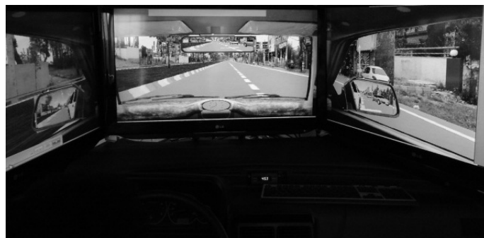
شکل ۴: سناریو شبیه سازی شده بدون تابلو در دستگاه شبیه ساز رانندگی
